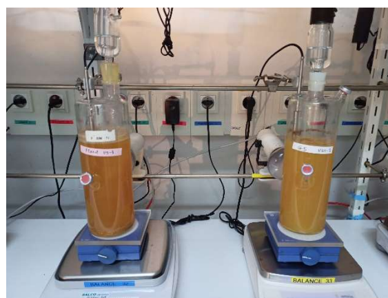
Figure 3. Fermenteurs d'1 L utilisés pour la fermentation des moûts de raisins blancs sur la plateforme PhenoFerm de SPO.
