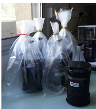
Figure 2. Cafetières à piston (Bodum) ensachées utilisées pour la fermentation des moûts de raisins rouges à l'UE Pech Rouge.
