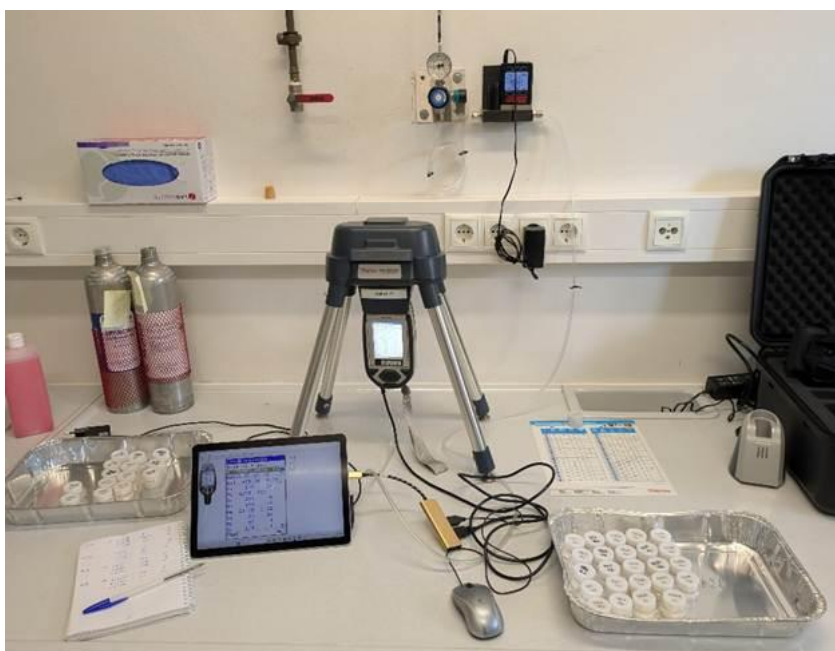
Figure 9 : Dispositif de mesure par pXRF au laboratoire Bodenkunden und Bodenökologie de Bonn
